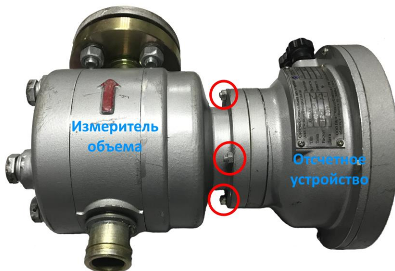
Рисунок 1 – Общий вид счетчика ДД-25/1,6 (ООО ПКФ «ПриборКомплект»).
