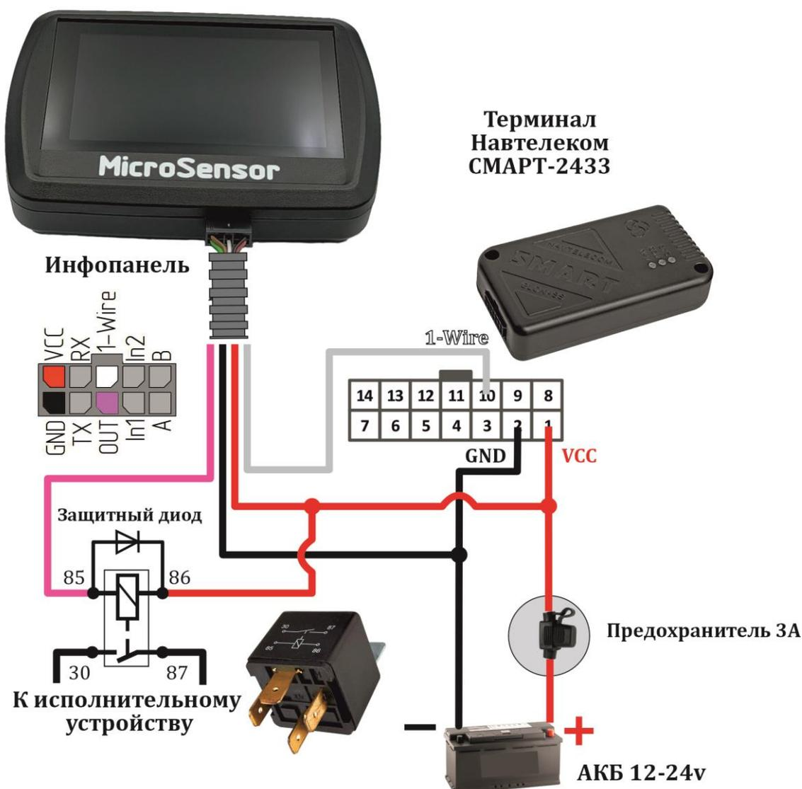
Во избежание повреждения выхода дисплея, рекомендуется подключать защитный диод параллельно реле. Необходимо выбрать защитный диод таким образом, чтобы прямой ток диода был в 1,5 раза больше тока удержания катушки.
