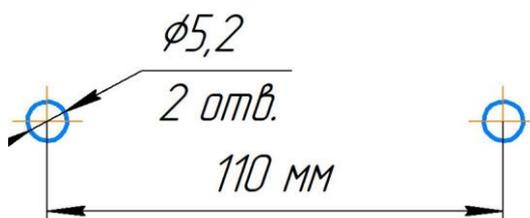
Рисунок 4 – Установочные размеры
